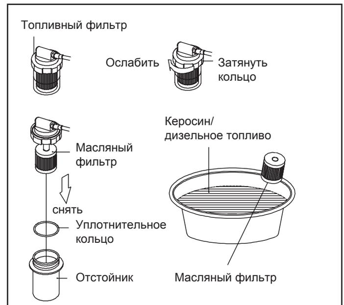
Рис 6. Обслуживание фильтра
